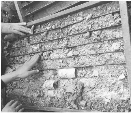
图2 绿泥石化地层岩心
