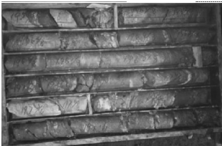
图3 使用成膜冲洗液采取的岩心
