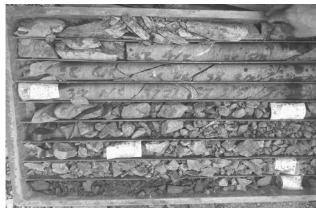
图 1 破碎地层岩心
