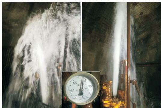
图3 KZK5313 钻孔孔内涌水情况
