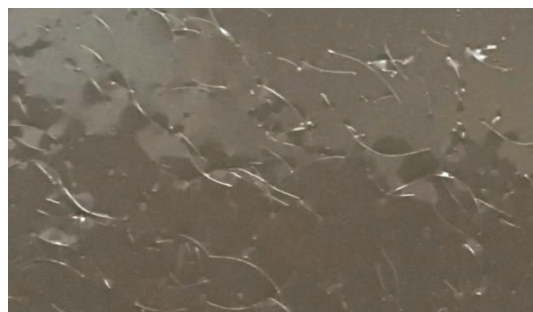
图3 高温养护后纤维在钻井液中的分散效果
