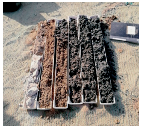
图3 SH30 型钻机取出的土样
