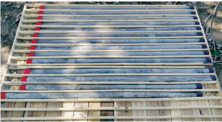
图 5 Geoprobe 型钻机贝勒管取样
