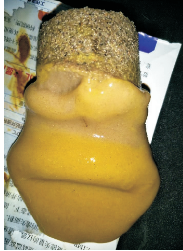
图2 6 MPa压力下凝胶封堵砂床后状态
