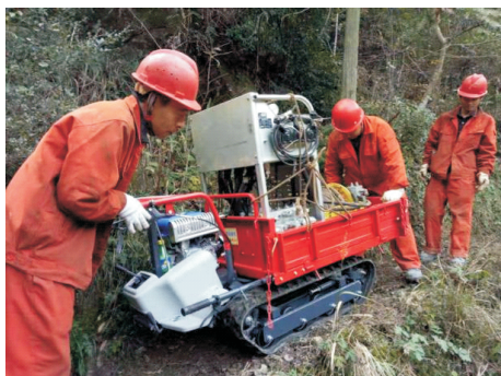
图10 小型履带式运输车
