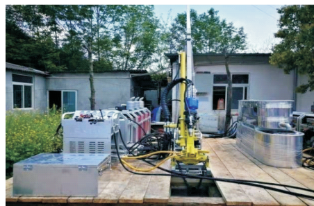
图1 原装EP600Plus型便携式全液压钻机
