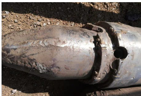
图8 二级导向扩孔钻头结构型式
