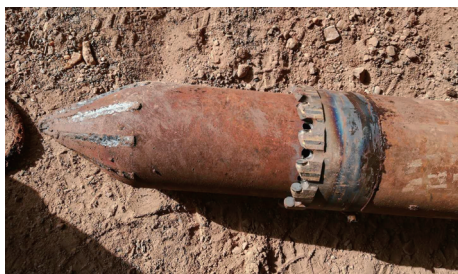
图7 一级导向扩孔钻头结构型式
