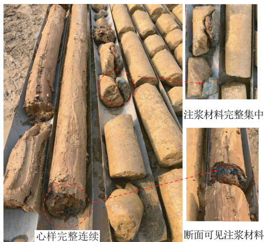
图10 现场钻孔心样验证
