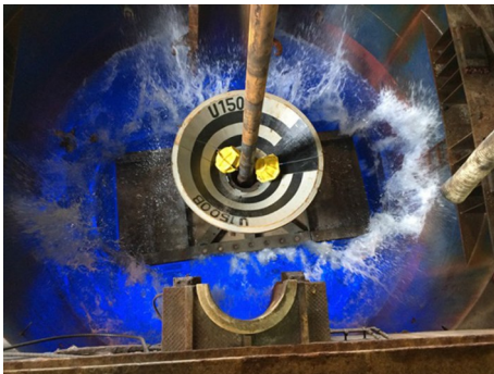
(a) 367 航次 U1500B 孔重入锥下放 (图片来源:Yifeng Chen, IODP JRSO)
