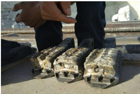
图 9 套管锻铣后的刀体磨损情况
