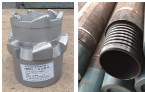
图2 套铣打捞钻头和钻杆
