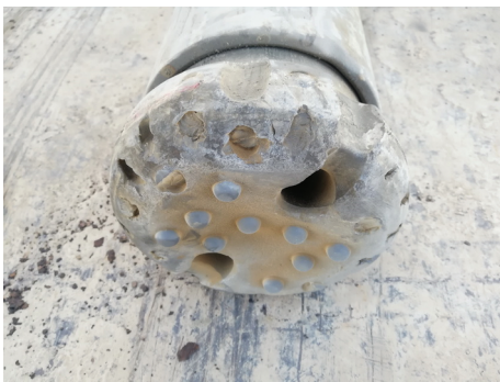
图1 GH-01井空气潜孔锤钻头磨损情况
