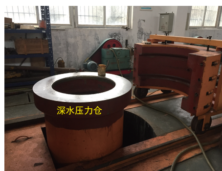
(b) 深水压力仓打压测试
