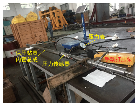
(a) 手压泵打压测试
