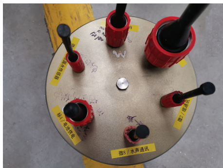
图4 水下电子舱接口
