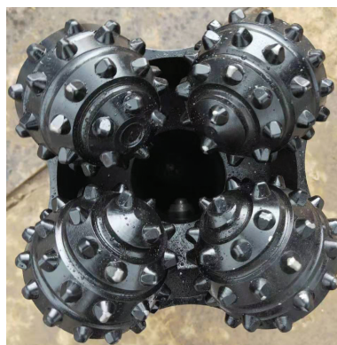
图3 8½ in 连续取心钻头
