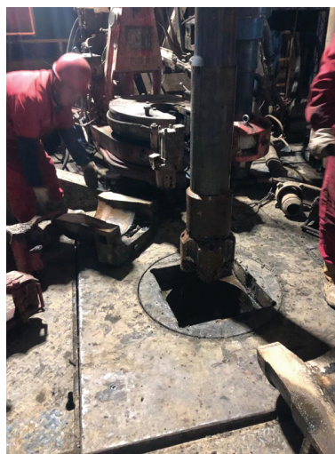
图6 12\frac{1}{4} in连续取心钻头下井试验
