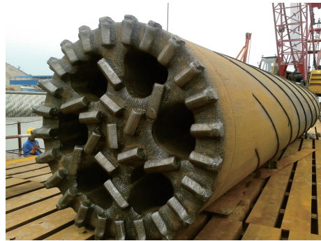
图1 现场冲击钻头
