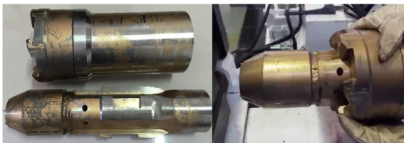
图 9 \varnothing 102\text{ mm}/\varnothing 140\text{ mm} 滚珠钻具实物
