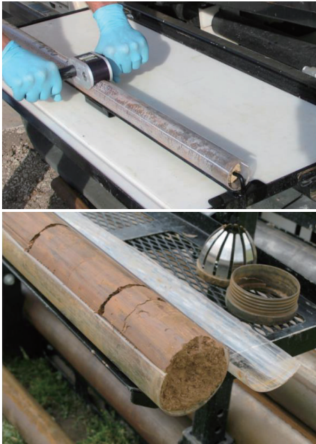
图 6 直推钻具取样效果
