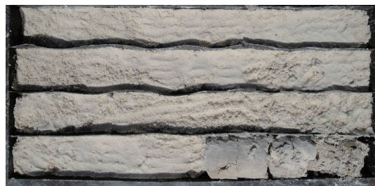
图5 吹填砂砾层岩心
