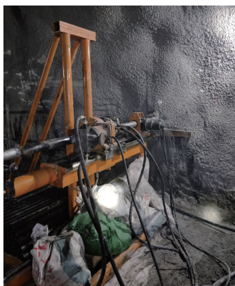
图1 KD-550型钻机 Fig.1 KD-550 drilling rig
