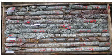
图4 绿泥石化、水云母化碎裂岩岩心
