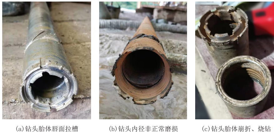
图6 钻头非正常磨损
