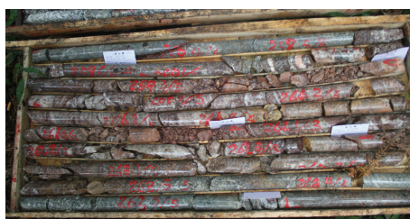
图5 赤铁矿化碎裂岩岩心
