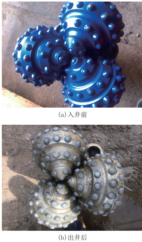
图4 牙轮钻头试验前后对比
