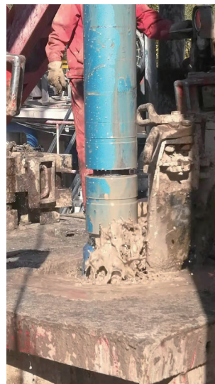
图3 液动冲击器井口性能测试
