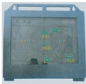
图 9 科尔维特孔底遥测系统操作员指示盘 Fig.9 "Korvet" display for the operator
