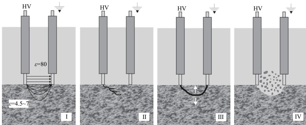
图1 高电压脉冲破岩机理
