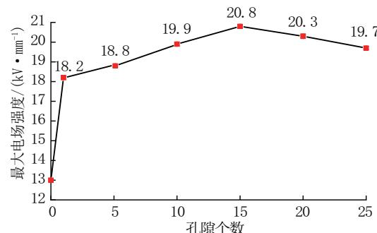
图11 孔隙个数对岩石内部电场强度的影响
