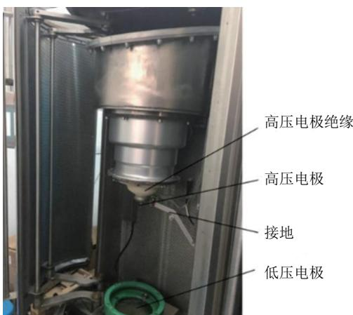
图2 高压工作电极部分
