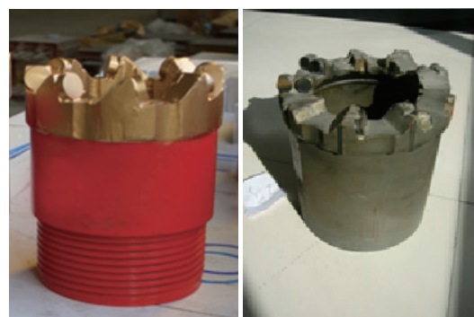
(b) 切削齿浑圆处理 (c) 切削齿结构排布优化
