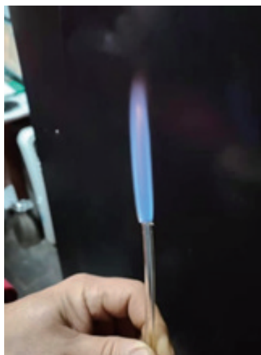
图2 录井色谱仪气路管线点火
