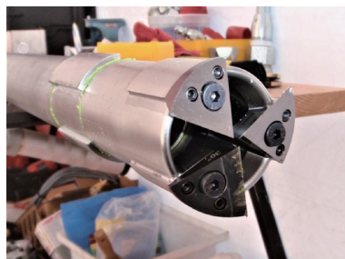
(a) 冰层全面钻进钻头
