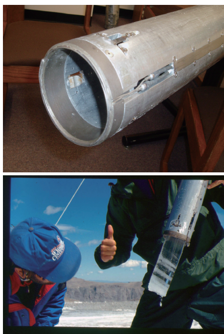
图16 IDP取芯钻钻头及获取的冰芯
