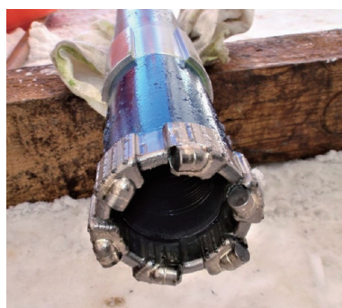
(b) 冰下基岩钻进取心钻头
