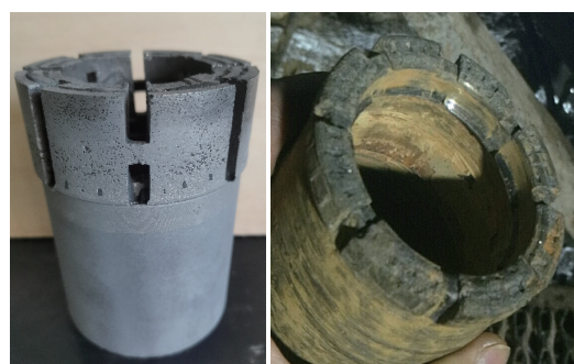
图16 \varnothing 76.5\text{ mm}/\varnothing 49\text{ mm} 内外加强仿蜈蚣爪趾环齿孕镶金刚石钻头
