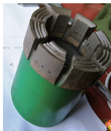
图17 现场用热压尖齿钻头
