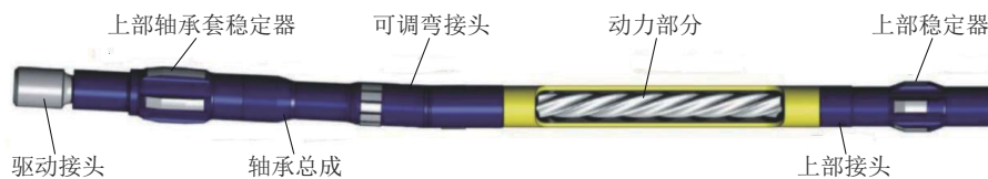
图6 耐温300℃螺杆钻具
