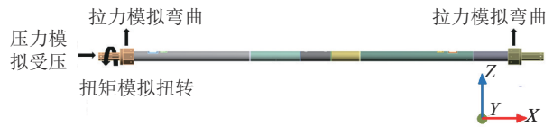
图 9 压弯扭组合载荷作用边界条件
