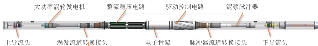
图2 675型仪器串泥浆脉冲器短节结构示意图
