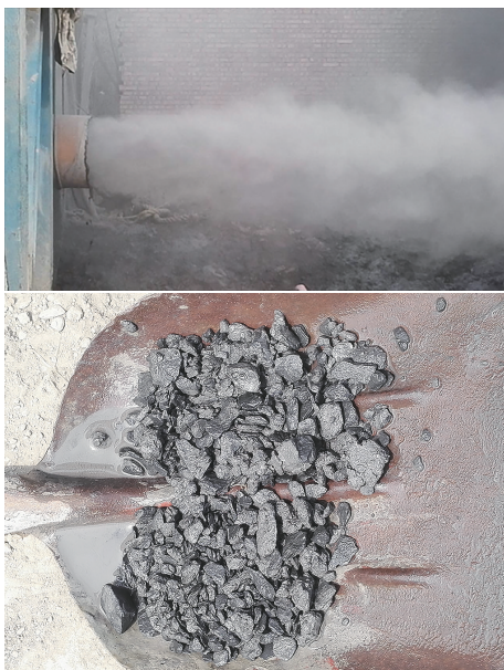
图9 跟管钻进上返的岩屑
