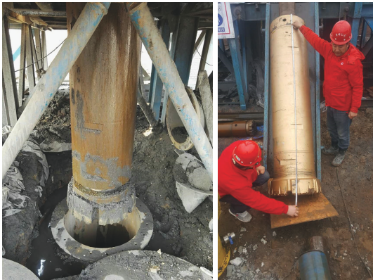
图6 TH24-650型大直径潜孔锤及钻头
