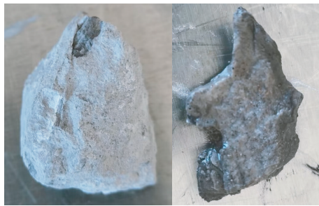
(a) 岩心经普通钙基冲洗液浸泡前后状态
