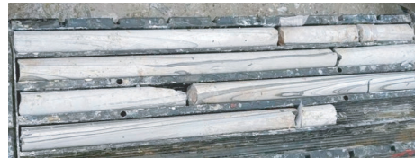
图4 钙基成膜环保冲洗液在390m处取出的岩心
