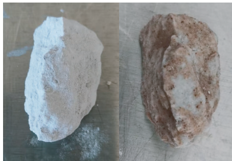
(b) 岩心经钙基成膜环保冲洗液浸泡前后状态
