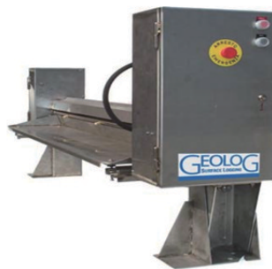
图3 翻转式岩屑流量测量装置(DrillClean系统)
