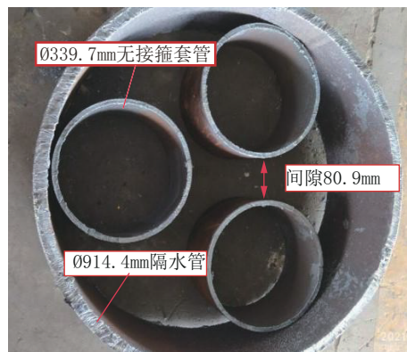
图4 单筒三井无接箍套管方案
