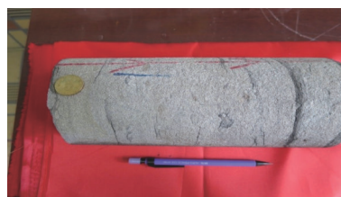
图 7 山西组(1417m)灰白色含气中粒石英砂岩
