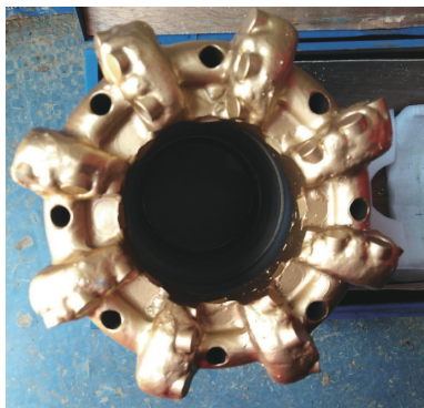
图 6 尖圆齿复合片取心钻头
