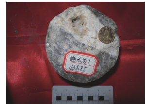
(d)皖太参1井1666.85 m,灰白色灰岩,裂隙方解石填充,见溶洞
