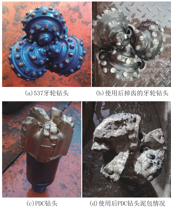
图 4 扩孔改造使用的钻头
