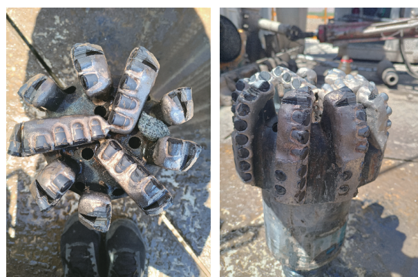
图7 九刀翼PDC钻头
