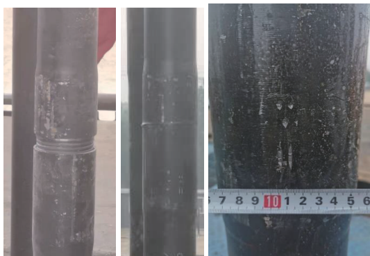
图2 Ø114 mm 绳索取心钻杆对扣、上扣情况
