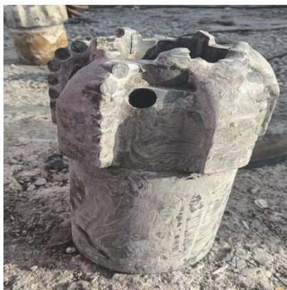
图6 订制的内加高侧喷取心钻头
