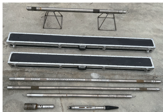
图9 存储式水平孔多参数综合测井仪器探管
