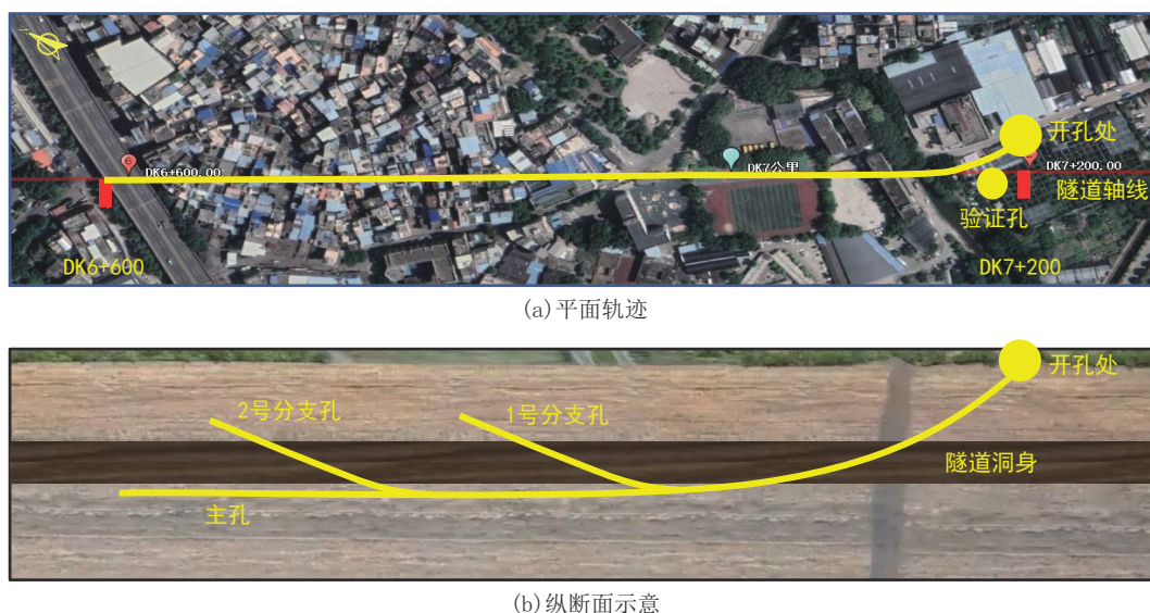
图2 DK6+600—DK7+200段定向钻孔布置示意
