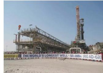
3000HP钻机是东方宏华专为ADNOC Drilling研制的新型人工岛平移钻机,该钻机分为主机平移模块、泥浆平移模块、动力模块和固定模块等4大模块,满足多人工岛排丛式井作业要求,是全球首批9000 m海洋人工岛超深井多排丛式井钻机。钻机不仅具有区域管理系统(ZMS)功能、离线作业功能,零排放收集系统、软泵、顶驱软扭矩和WPS等功能;更采用机电数字一体化设计,实现了自动化、智能化、信息化。钻机各部分的结构设计采用了国内外成熟的先进技术,工作可靠、运移方便、运行经济,全面满足HSE要求。
