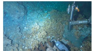
国家重大科研仪器研制项目“深部岩石原位保真取芯与保真测试分析系统”历经数年攻关,成功自主研发了深海沉积物(天然气水合物)保温保压取样器。2022年9月23日,在海南省深海技术创新中心组织的“深海深渊科考与装备海试共享航次”下,深海沉积物(天然气水合物)保温保压取样器搭载于我国4500 m级载人潜水器“深海勇士”号,在南海1370 m水深区域完成既定作业任务,获得保持原位压力13.8 MPa、温度6.51℃的深海沉积物(天然气水合物)样品,突破了深海沉积物(天然气水合物)保压取样技术难题,攻克了深海沉积物(天然气水合物)保温取样技术世界空白,实现了全球保温保压沉积物(天然气水合物)样品获取零的突破。
