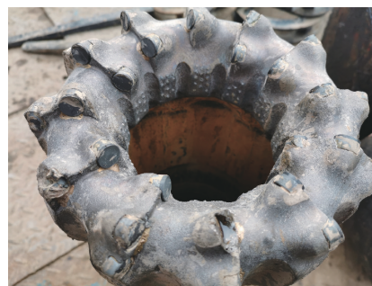
图 5 PDC 钻头切削齿冲击损坏情况
