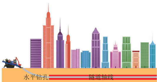
图2 城市地下轨道水平勘察孔示意
