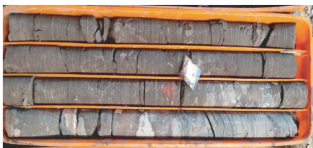
图7 运用成膜B剂获取的红色砂岩岩心
