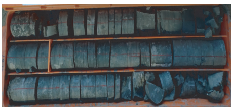
图6 运用成膜B剂获取的黑色泥岩岩心
