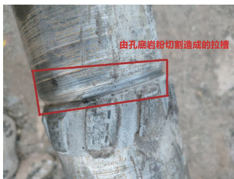
图3 钻具拉槽
