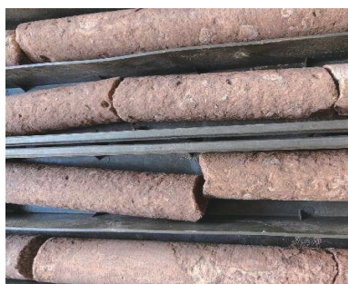
图 1 以往钻孔采用氯化钠盐水钻井液获取的盐矿心
