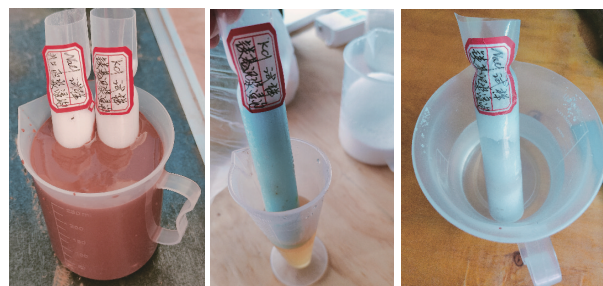
(a) \text{NaCl} 、 \text{KCl} 试样镁基泥浆浸泡96h (b) \text{KCl} 试样在清水中浸泡1h (c) \text{NaCl} 试剂在清水中浸泡30min
