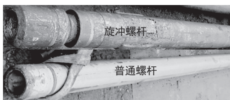
图 3 螺杆钻具实物照片
