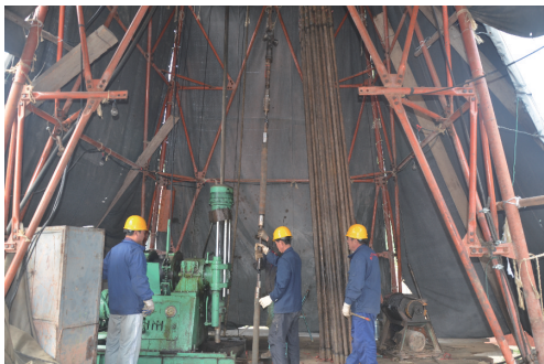
图4 水压致裂印膜试验
