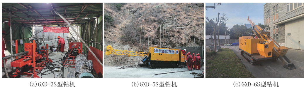
图1 GXD系列水平定向钻机
